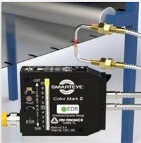
**Modo alternativo (B):** Fibra óptica a través del haz
